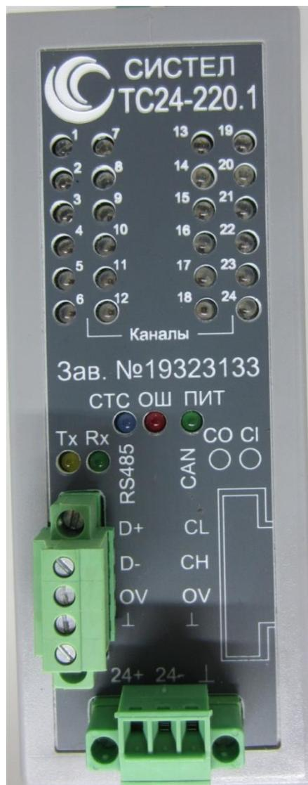
Рисунок 1 – Общий вид модуля ТС24-220.3 с расположением разъемов
